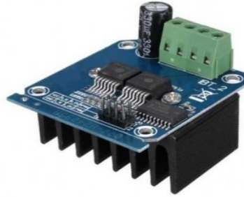
Şekil 5.2. Dc motor sürücüsü (BTS7960B)
